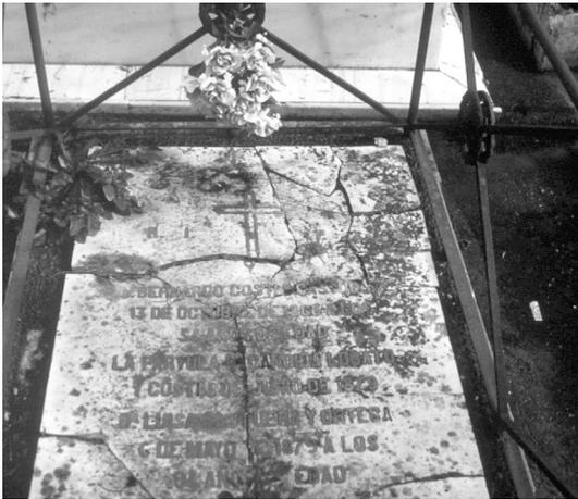
Figura 5. Foto de lápida de mármol del siglo XIX, que ha sufrido fragmentación por acción mecánica, disolución y aumento de tamaño de dichas grietas por el agua de lluvia -ácida a veces-, acción de la helada -que ha desplazado los bloques a ambos lados de las grietas y acción de líquenes y microorganismos edáficos.
