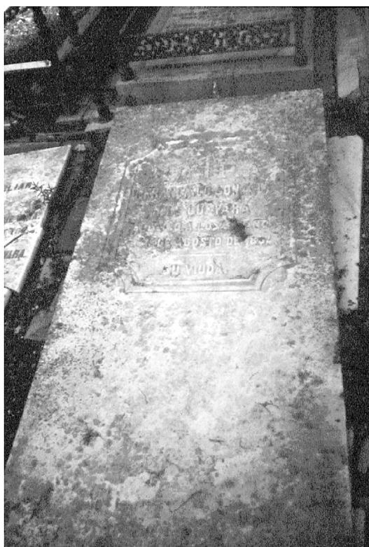
Figura 4. Acción de líquenes y disolución kárstica –aumento del volumen de grietas y desgaste en aristas– sobre una lápida de caliza de 1834
