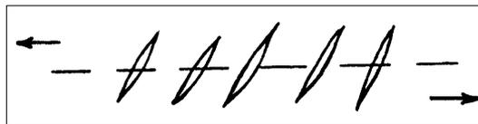
Figura 17. Al aplicar una compresión horizontal en una de las mitades del recipiente de plástico, surgen pequeñas fracturas, denominadas hendiduras o fisuras de tracción.
