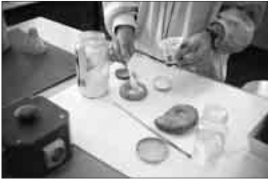
Foto nº 5: Vertido de escayola fluida sobre el molde de plastilina, previamente impregnado de aceite, para obtener la réplica del molusco.
