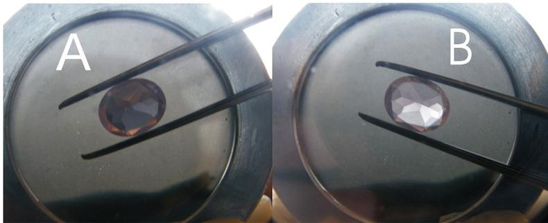
Fig. 11. Observación de una amatista entre polarizadores cruzados; la luz no pasa a través de ellos. A: posición de extinción. B: a 45° de la anterior la gema se ve iluminada (ver Fig.10).
