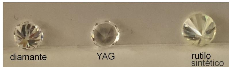
Fig. 5. Diferencia de brillo entre tres gemas con la misma talla brillante: diamante ( $n=2,42$ ), YAG (sintético, óxido con estructura granate  $Y_3Al_5O_{12}$ ,  $n=1,83$ ) y rutilo ( $n=2,61-2,91$ ). El brillo del YAG es muy inferior al de los otros dos. La imagen muestra la culata de las gemas, por lo que los destellos de color debidos a la dispersión sólo se aprecian en el rutilo (con un tono amarillento), debido a su altísima dispersión (0,330), frente a 0,044 del diamante y 0,028 del YAG.
