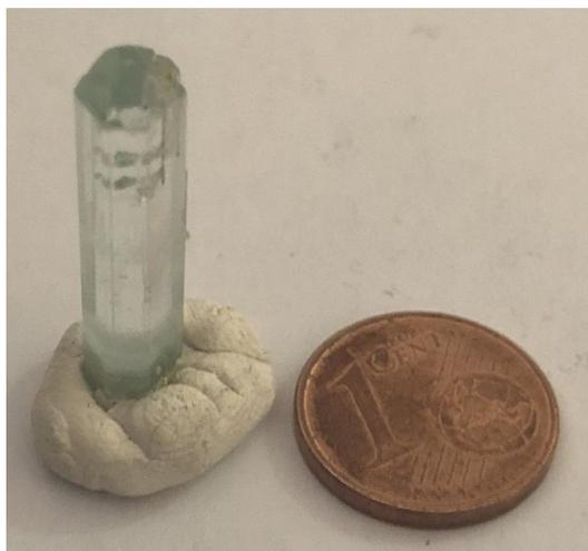
Fig. 6. Cristal prismático de aguamarina en bruto. El tono verdoso indica la presencia de  $\text{Fe}^{3+}$  en los canales que no ha sido reducido por tratamiento térmico.
