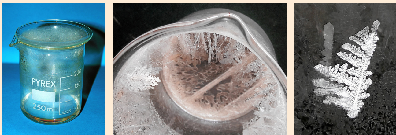
Fig. 12. Obtención de cristales de naftaleno por sublimación. A la izquierda, el naftaleno fundido emitiendo vapores, en el centro cristales formándose en el interior del líquido y a partir del vapor en las paredes; a la derecha, detalle de los cristales.
