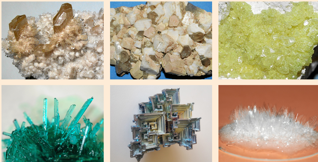
Fig. 10. Arriba, de izquierda a derecha: grupo de cristales de yeso; agregado de cristales de cuarzo, ortosa y albita; cristales de azufre. Abajo, en el mismo orden: cristales de sulfato de níquel (evaporación), bismuto (a partir de fundido) y naftaleno (por sublimación inversa).
