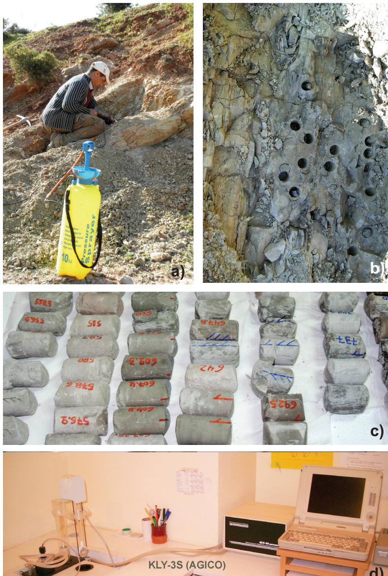
Fig. 5. a) Muestreo en el campo con taladro eléctrico con adaptador para broca especial y refrigerado con agua. b) Aspecto del afloramiento una vez extraídas las muestras. c) Muestras cilíndricas para su análisis de ASM tomadas del sondeo Martón-1 realizado en Zuera (prov. Zaragoza) para analizar los depósitos continentales Cenozoicos de la cuenca del Ebro. d) Aparato de medida (susceptómetro) del Laboratorio de Fábricas Magnéticas (Dpto. Ciencias de la Tierra) de la Universidad de Zaragoza. Foto cortesía de Teresa Román.
