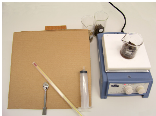
Fig. 9: Materiales necesarios para determinar la viscosidad de las coladas de lava según su temperatura.
