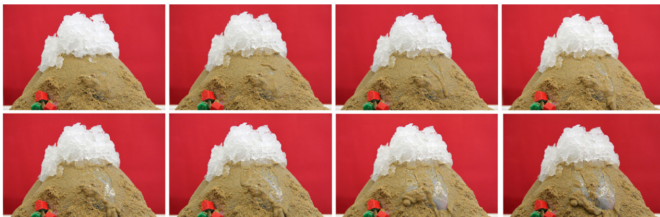
Fig. 21: Resultado de la fluidificación de la arena superficial que forma el cono volcánico simulando la secuencia de un lahar.
