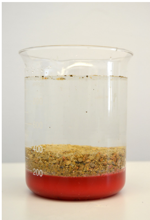
Fig. 4: Preparación del experimento del ascenso magmático colocando una capa de cera sólida, una de arena y agua en un vaso de precipitados.
