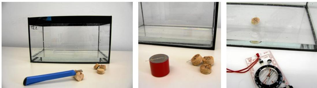
Fig. 3: a. Cortando los corchos con un centímetro de espesor. b. Frotando los alfileres para magnetizarlos. c. El alfiler encima del corcho se orienta con el dipolo magnético, comprobado con la brújula.
