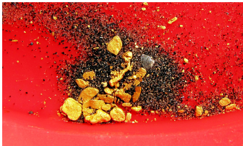
Fig. 7. Concentrado aurífero obtenido por bateo en las aguas del Río Sil.
