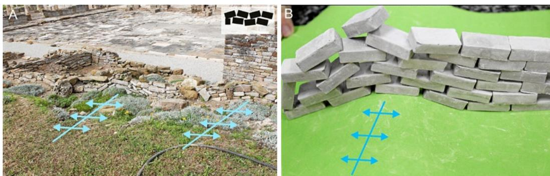
Fig. 16. A) Tiendas del foro de la ciudad romana de Baelo Claudia en el sector Este, los ejes azules indican los ejes de plegamiento del muro; B) deformación con simulación de ondas Rayleigh sobre lámina de “goma eva” movida por un tubo.
