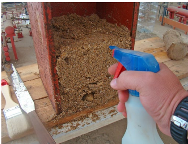
Fig. 4 (izquierda). Aplicación de la primera capa de laca con un difusor.
