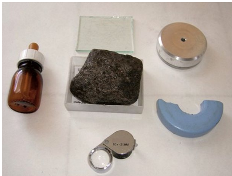
Fig. 3. Diferentes utensilios que se utilizan en la identificación de minerales a partir de sus propiedades macroscópicas: ácido clorhídrico diluido, lupa, imán, placa metálica, placa de vidrio, ...
