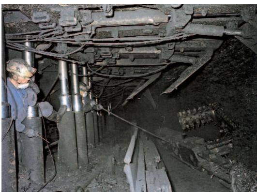
Fig. 3. Taller “automarchante” con rozadora en Hullas del Coto Cortés, Asturias. Fotografía por cortesía de UMINSA.
