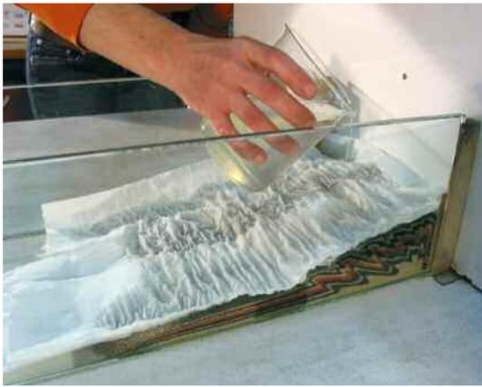
Fig. 2. Saturación con una disolución de gelatina, de un modelo de pliegues y cabalgamientos realizado con arena. Observe como se ha tomado la precaución de proteger la superficie del modelo con papel higiénico. Las partes más oscuras del modelo son las saturadas en gelatina.
