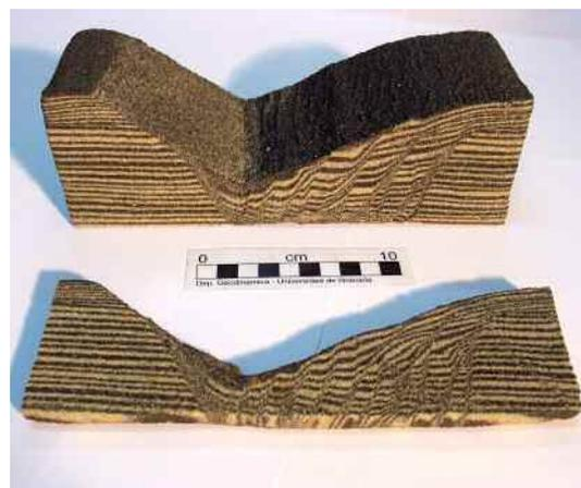
Fig. 4. Ejemplo de maqueta de mayor dimensión y loncha del mismo modelo. Este ejemplo corresponde a un sistema de fallas normales. El secado se hizo según el procedimiento descrito.
