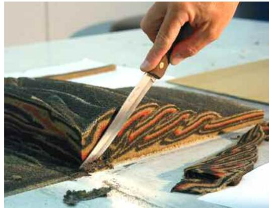
Fig. 3. Cortes en lonchas del modelo parcialmente endurecido con gelatina, lo que permite tanto desmoldarlo como cortarlo con un cuchillo de cocina. Este ejemplo corresponde a un sistema de cabalgamientos.
