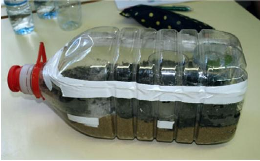
Fig. 14.- Ejemplo de maqueta cerrada, preparada para estudiar la evaporación y la condensación.
