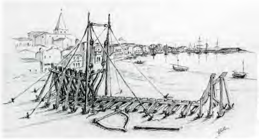
Fig 1. Els mestres d'aixa de Palamós treballaren, durant el segle XIX, al lloc de la platja on actualment hi ha el Passeig del Mar: com que no disposaven de drassanes cobertes, ho feien a l'aire lliure i es servien d'uns estris molt senzills per a poder anar col·locant les quadernes i els objectes més pesants sobre el bastiment, com es pot veure en aquest dibuix basat en un model d'una maqueta del Museu Marítim de Barcelona (ref 3.326).
