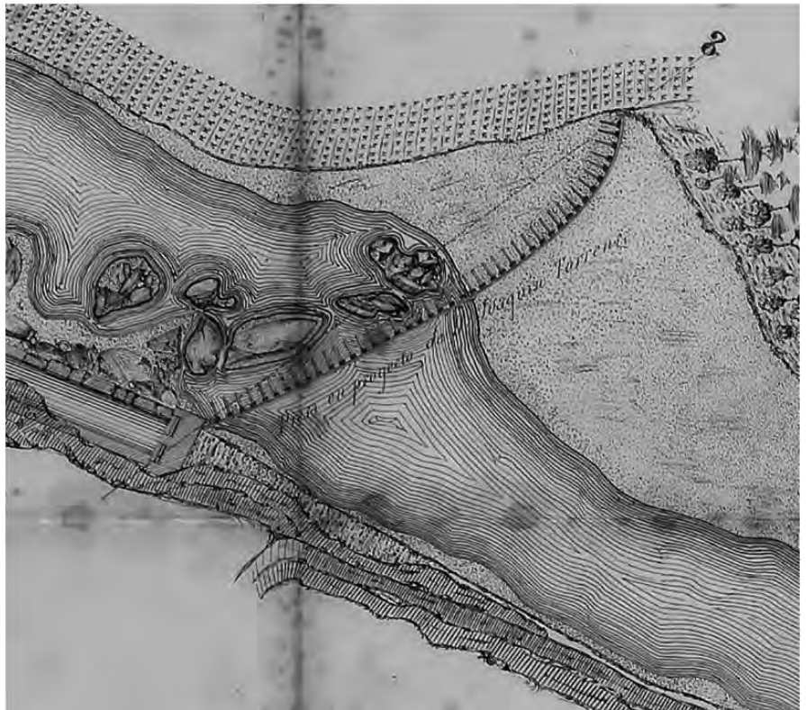
Plànol original de l'aprofitament hidràulic per a una fàbrica de filats i teixits de cotó i un molí fariner al riu Cardener, terme de Callús (Barcelona), 1871. (Arxiu General de la Diputació de Barcelona, secció Foment, Aigües).
