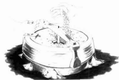
Reconstrucció hipotètica del funcionament d'un molí manual rotatori. (Dibuix: Jairo Martín).
