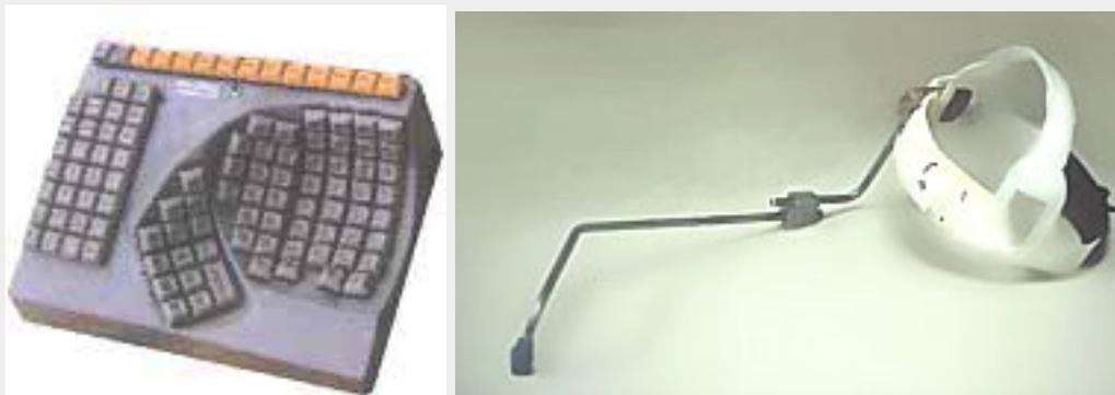
*Dos ejemplos de ayudas técnicas: un teclado adaptado a personas que sólo pueden mover la mano derecha (primera imagen), y un dispositivo que colocado en la cabeza, sirve para las personas puedan pulsar las teclas del ordenador (segunda imagen).*
