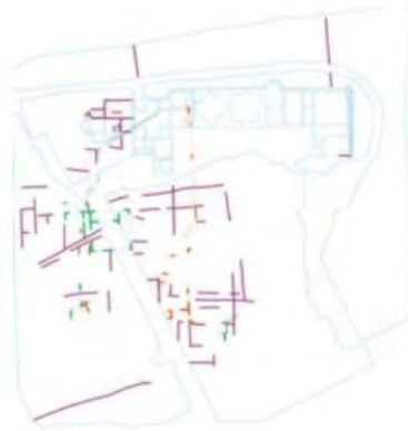
Figura 12b. Interpretació dels resultats obtinguts de la lectura del sòl mitjançant magnetòmetre on s'hi poden apreciar restes de diferents construccions. (Prevosti, Marta; Strutt, Kristian; Carreras Monfort, César – (2010) The ager tarraconensis project (right side of river Francoli) (PAT): the application of geophysical survey to identify rural Roman settlement typologies ICAC http://hdl.handle.net/2072/223598
