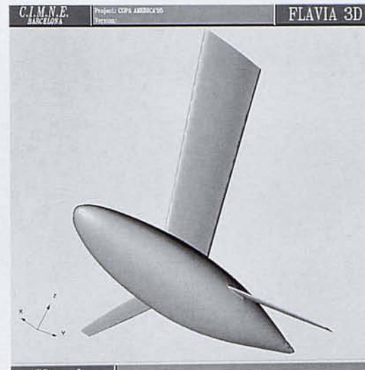
MODELO GEOMÉTRICO PARA ANÁLISIS HIDRODINÁMICO DE LA QUILLA DE UN VELERO
