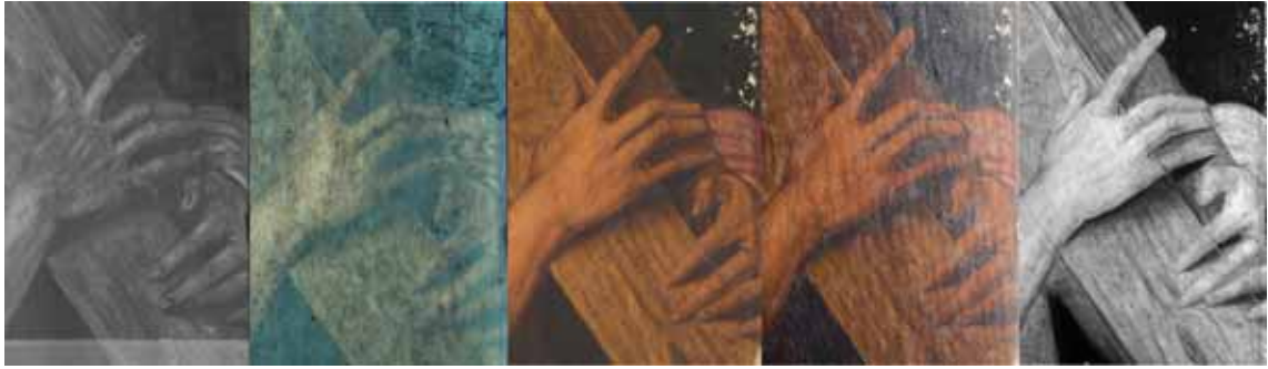
Fig. 4. Mostra de les diferents tècniques d'anàlisi no destructives: d'esquerra a dreta, RX, UV, llum visible, llum rasant i RIR.
