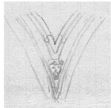
Fig. 15. Detall de Fig. 7 (fol. 15v, d), amb el motlluratge d'un carcanyol acabat en cap.
