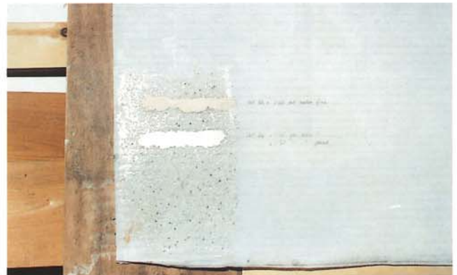
Proves d'adhesió de la càrrega al policarbonat.
