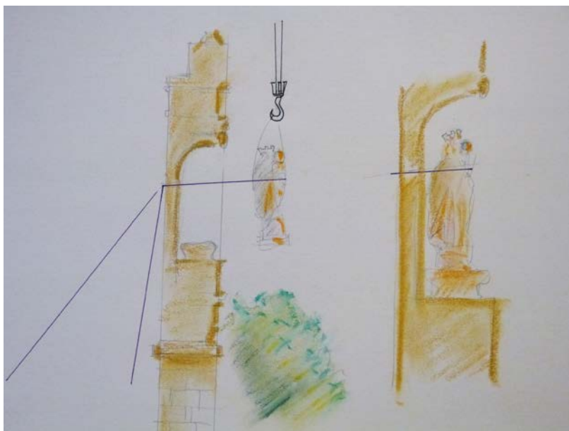
6. Croquis que justifica el sistema: les cordes, en tirar pel darrera la vertical de la grua, fan que l'escultura vagi entrant dins la fornícula, amb moviments cautelosos i molt pausats.
