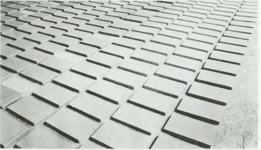
Primera fase de secado: disposición de los ladrillos (o «tegulae»), tendidos horizontalmente en el suelo de la era.
