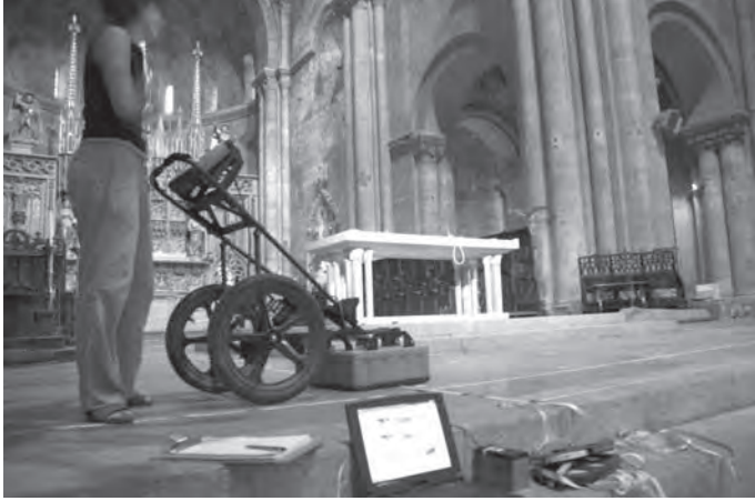
Figura 9. Instante de la prospección geofísica mediante el georádar.
