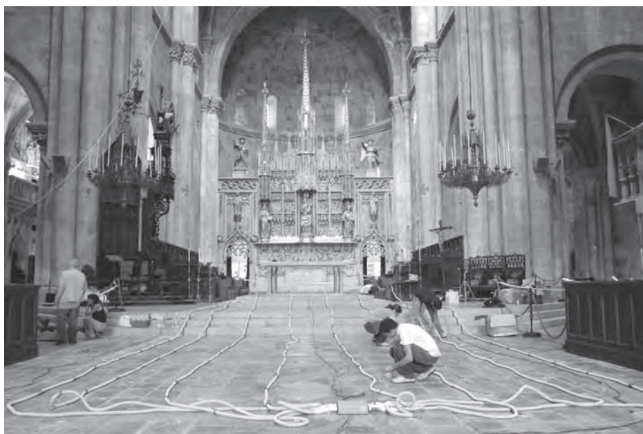
Figura 8. Proceso de implantación de electrodos en el área del ábside para la obtención del modelo tridimensional.
