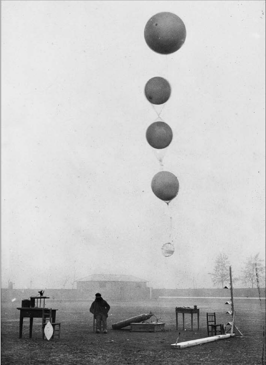
Figura 4. Fotografia dels sondatges amb globus captius realitzades al camp de futbol de Vic els dies 24 i 25 de gener de 1925. Com es veu, quatre globus agafats per una xarxa (que s'íntueix) sostenen una cistella on es troba el meteorògraf. La base de l'equip està formada per un tauló on està fixat el carret de fil. Com es pot observar, el dia començava amb boira i també sabem la temperatura del moment, -4.0^{\circ}\text{C} . La persona asseguda calça esclops per protegir-se millor del fred (reproducció de l'original dipositat al fons antic del Servei Meteorològic de Catalunya, Cartoteca de Catalunya, ICC).
