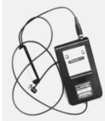
Imagen 16. Un sensor permite seguir la posición de cada fanalet en un espacio tridimensional.
