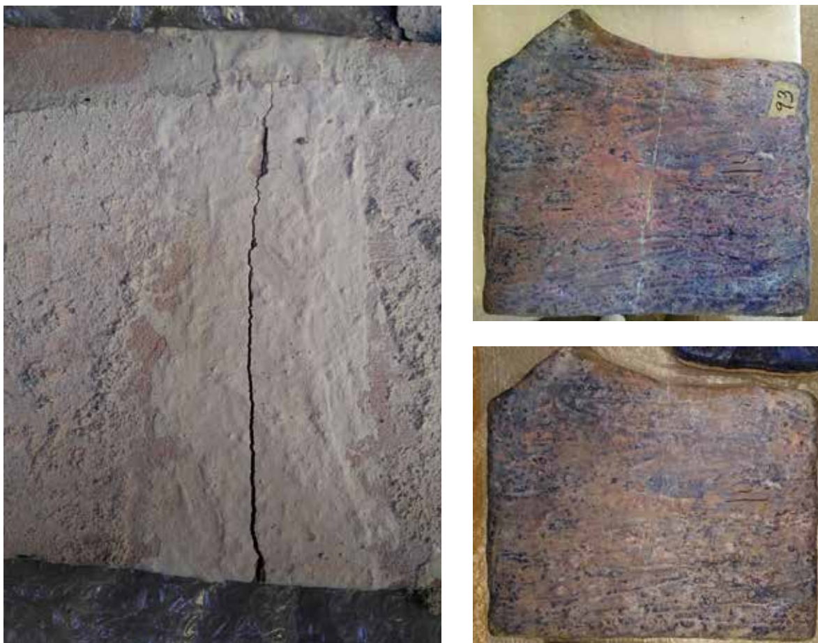
Figura 8: Restes de morter d'injecció i fractura de la peça, 2016. Fotografia: Marina Granero. Figures 9 i 10: Reintegració matèrica i cromàtica. Abans i després, 2016. Fotografia: Marina Granero.
