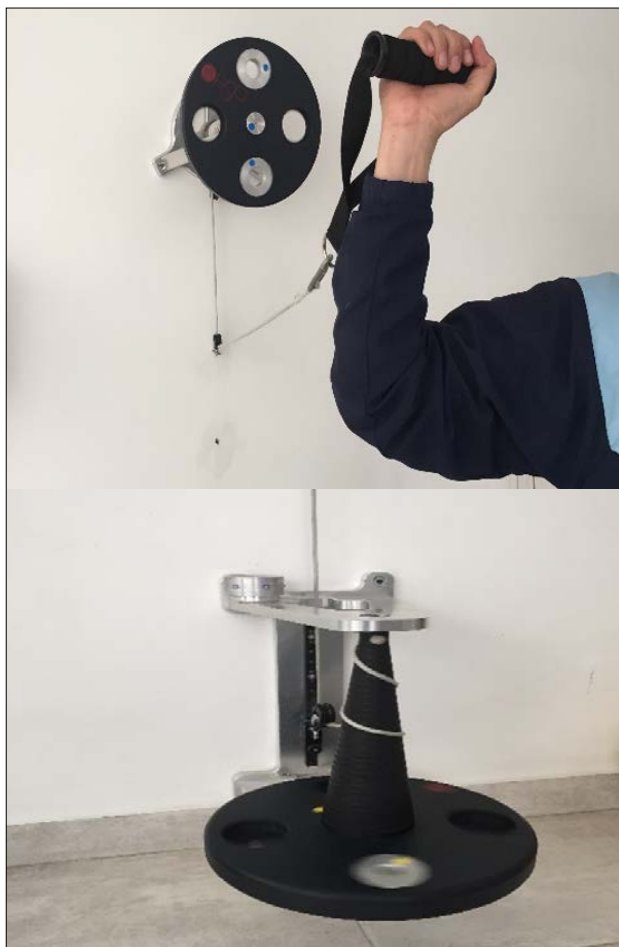
Figura 3 Politja de radi fix (a dalt) i politja cònica isoinercial (a baix).
