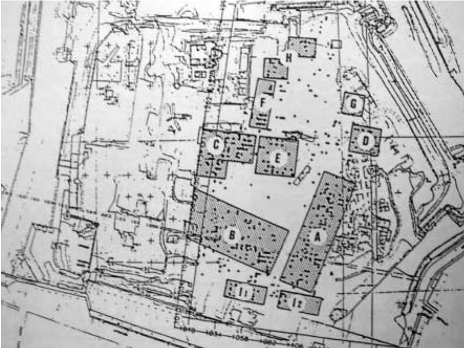
Localització de les prospeccions geofísiques. MARÍ, pàgina 416, figura 3. Sens dubte, les anomalies del sector B estan relacionades amb els moviments de terra originats pel fossat obert per Pizaño en 1544, així com el reompliment de l'estructura fet anys més tard per Calvi.
