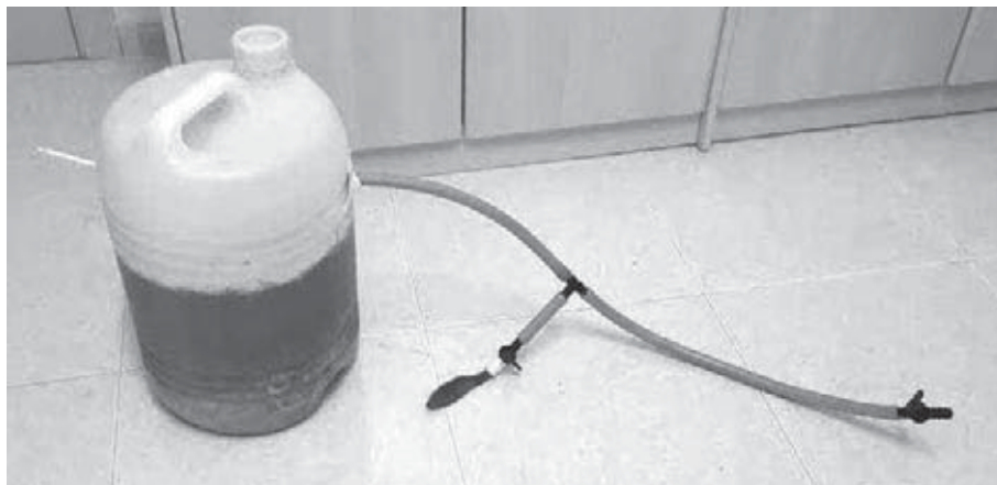
El biodigestor definitiu ja construït.
