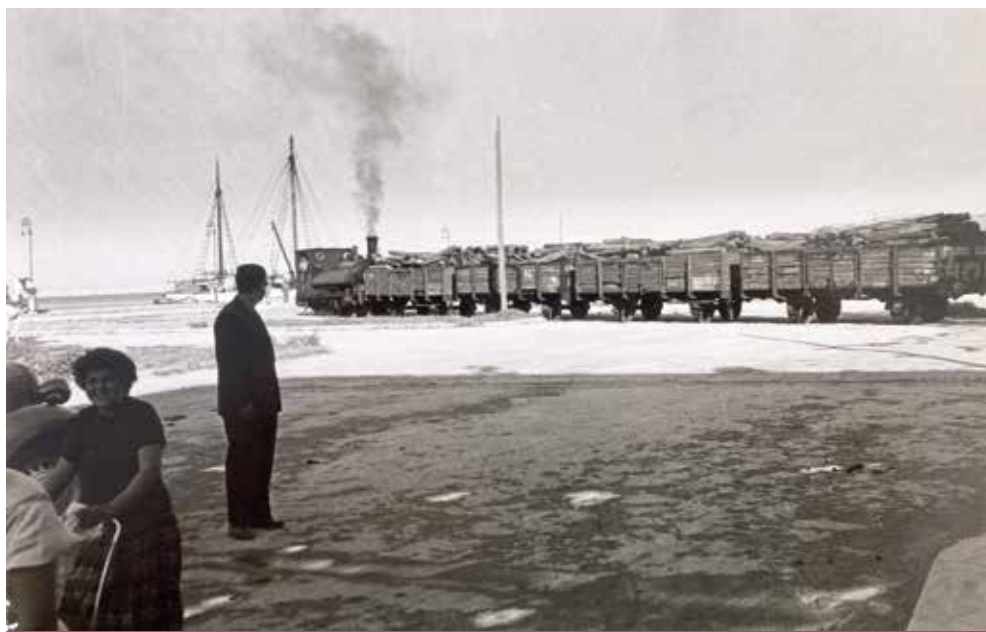
Extraordinari document gràfic d'una composició formada per una locomotora 220 ST de la companyia del Nord amb una composició de 4 vagons travessant el carrer Castell d'Olimbroi. Cal observar que el segon vagó per davant de la locomotora pertanyia al ferrocarril Alcoi a Gandia. Doc. col. Pepe Ronda.
