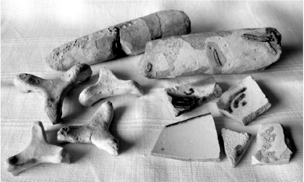
Trébedes y rulos para apilar las piezas en el horno y restos de loza estannífera fallida, en verde y manganeso, y cobalto. Alfarería de los Haberes de Ademuz. Colección del autor.
