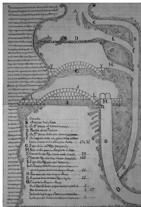
Fig. 7. 1793. Projecte inclòs en el primer llibre d'actes de la Junta de Propietaris per a canviar la presa de la séquia Major a causa d'una riuada. De dalt a baix: assut antic que desviava les aigües a la séquia del Moro, presa projectada i presa de la casa de les Taules (sig. 41/5).
