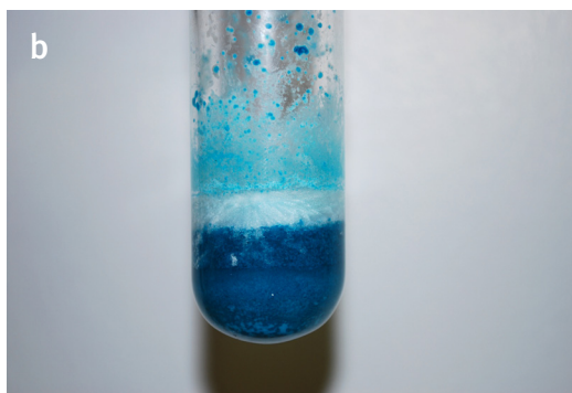
Fig. 3. a. Sulfato de cobre y etanoato sódico calientes (con un poco de etanoato sódico sin fundir en la base) (P. Kennett) b. La mezcla tras su enfriamiento, con una capa de cristales de sulfato de cobre cubierta por cristales de etanoato sódico (P. Kennett)
