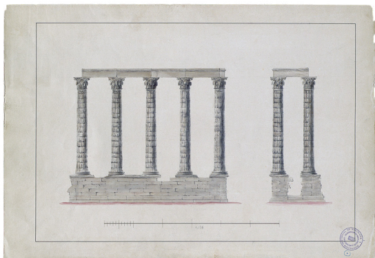
FIGURA 3. Antoni Celles, alzado frontal y lateral de las fachadas del templo romano de Barcelona, con las columnas existentes, 1835. Escala métrica (?), pies castellanos (?), 29,3 x 42,6 cm. Cartulina, tinta negra y acuarela gris y rosa. En el ángulo superior izquierdo hay manuscrito a lápiz el número 7. © AGDB. Fons Diputació de Barcelona, SCCM 346/20/12/1.
